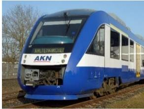
Ein von der AKN für mehrere Jahre angemietetes Fahrzeug des Typs Lint 41 (Leichter Innovativer Nahverkehrs Triebwagen, 41 Meter) fährt seit März 2021 auf der Linie A3 zwischen Ulzburg Süd und Elmshorn. Er wurde von der Firma Alstom in Salzgitter gefertigt, ist mit zwei Antriebsmotoren sprintstark und bietet mit 155 Sitzplätzen viel Platz, einen barrierefreien Zugang und Klimaanlage.
